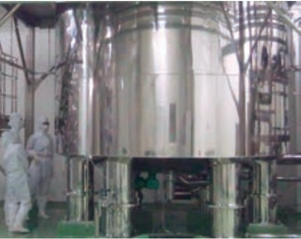
細胞・ウイルス培養用の大型タンク
